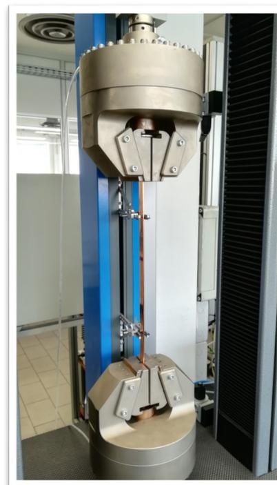
Foto: dettaglio morsetto ed estensimetro
